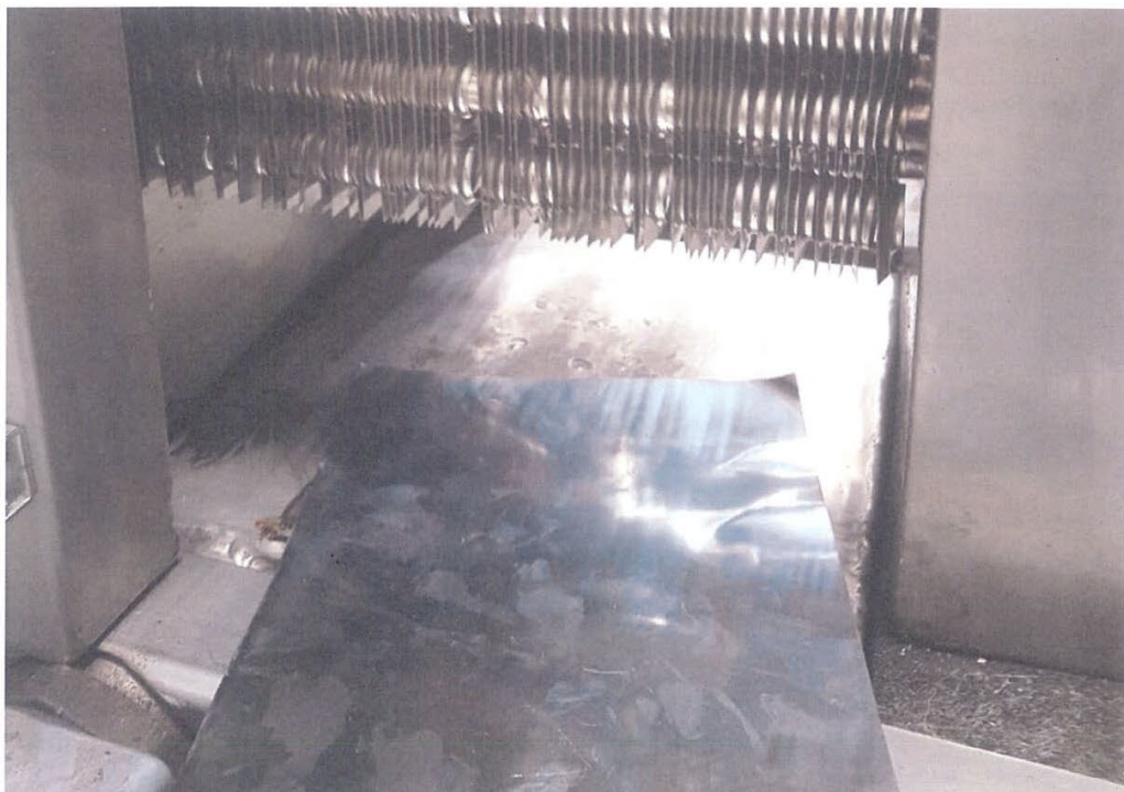
Figur2. Tørkekammer med sirkulerende varmluft varmes av varmebatteriet lagd med den spesielle legering som gir resultater i varmestråling hvor vannet har maksimal absorpsjon.
